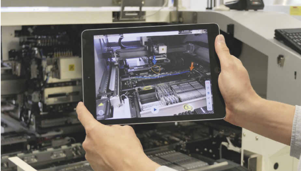
Virtuelle Fehlerdiagnose live und in Echtzeit mittels Pilot APP „JUKI Detect“.
